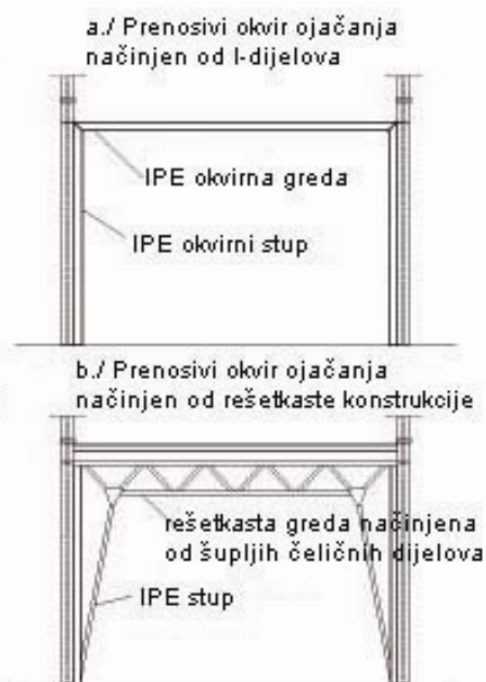
Slika 18: Vrste longitudinalnih ojačanja prenosivih okvira
